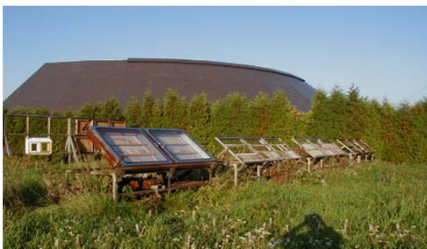
図1 板ガラスを通過した太陽光に暴露
