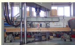
↑曲げ強度試験 ↓そぎ割れ型の破壊
