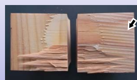
写真4 接着不良の様子 接着層に大きなすき間
