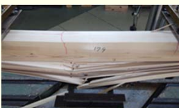
↑曲げ強度試験 ↓そぎ割れ型の破壊
