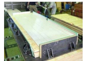
写真3 CLTパネル製造試験
