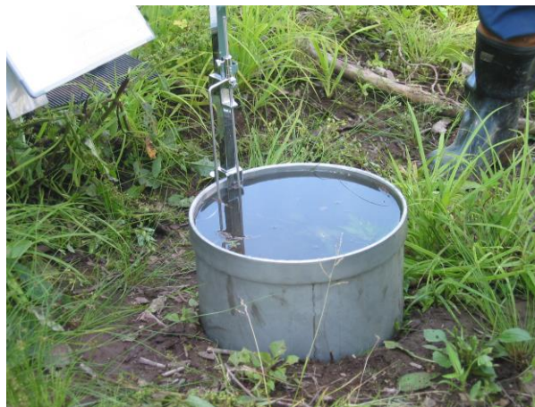
写真-1 冠水式の浸透能測定器
