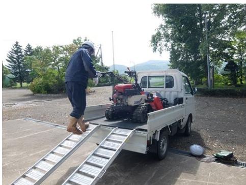
写真－1 自走式刈払機積込みの様子
