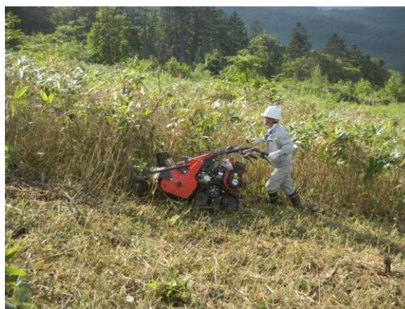
写真-6 歩行型刈払い機による地拵え作業
