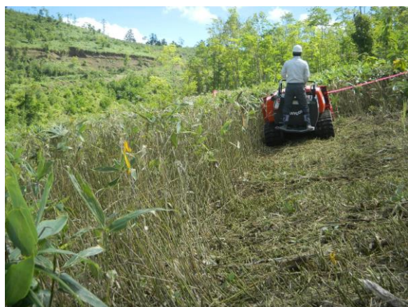
写真-5 乗用型刈払い機による地拵え作業
