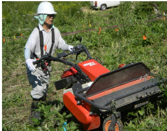
写真-2 歩行型刈払い機 CG101 (ブッシュカッタージョージ Jr. 草薙) 長さ：1.8m, 幅：1.0m, 高さ：1.0m 質量：260kg 価格：969,840 円
