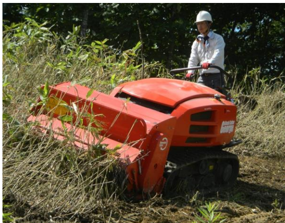
写真-1 乗用型刈払い機 CG431 (ブッシュカッタージョージ) 長さ：3.5m, 幅：1.7m, 高さ：1.4m 質量：2t 価格：9,720,000 円
