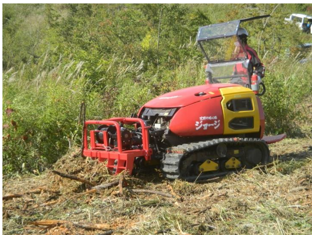
写真-8 レーキアタッチメント（2018年9月）
