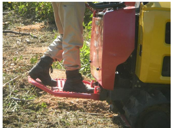
写真-1 傾斜の付いたステップ（2018年10月）
