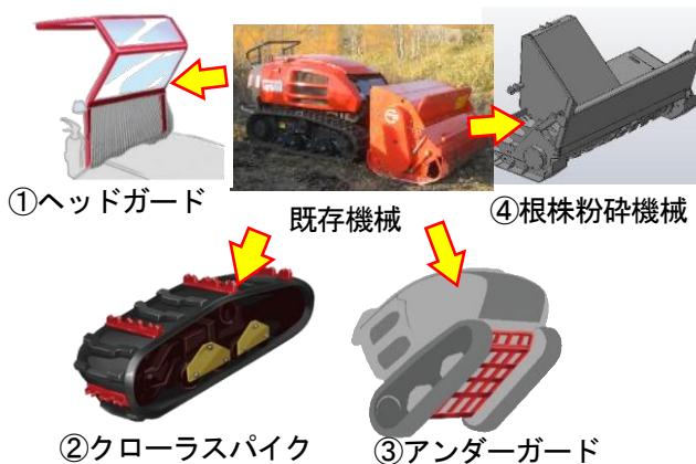
図-1 既存機械からの主な改良点
