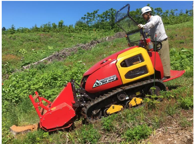
写真-6 根株粉碎中の山もつとジョージ (2019年6月) *左下にカラマツ根株が見える
