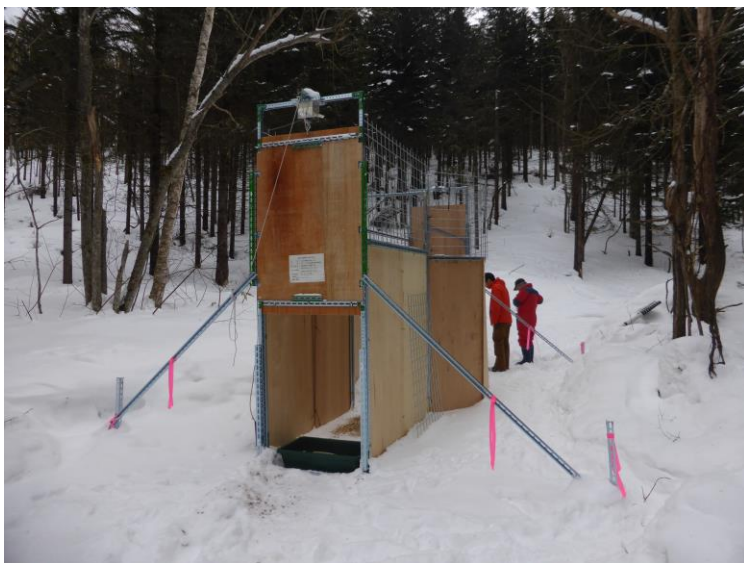
写真-1 北海道立総合研究機構環境科学センターが開発した体重計測式小型囲いわな
