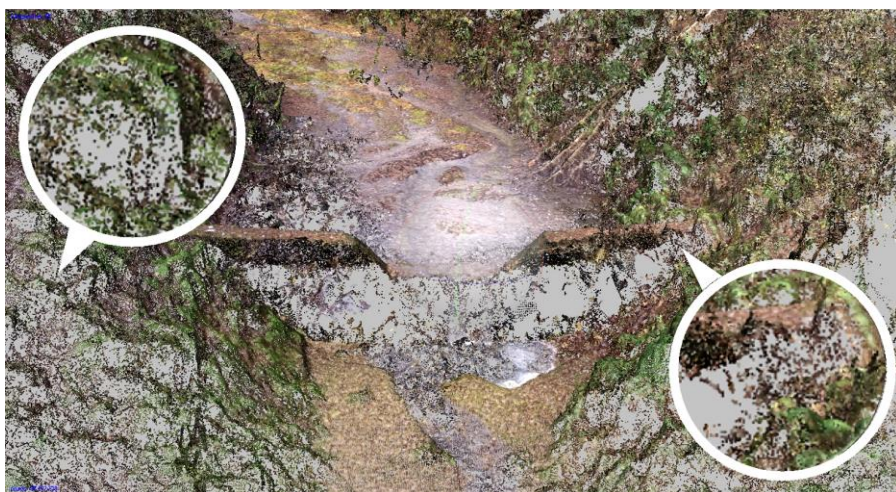
図-1 3D点群データ化された治山ダム。無数にある点のそれぞれに対して、色情報・3次元位置座標などが付与され、様々な情報が抽出できる。
