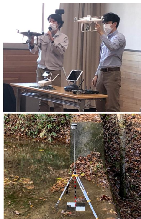
写真-3 実際に用いた小型UAV（上） とGNSS(Trimble R2;NIKON Trimble社)による対空標識 (白黒マーカー)の位置測定（下）
