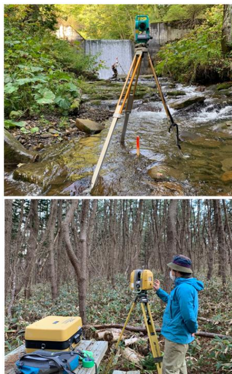
写真-2 トータルステーション（上） 地上型レーザースキャナ（下）
