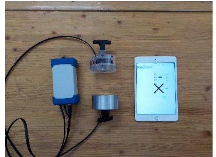
写真-12 開発された音響振動を利用した樹木内部簡易測定機
