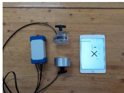
写真-12 開発された音響振動を利用した樹木内部簡易測定機 現在はリニューアルされて異なる形態になっています
