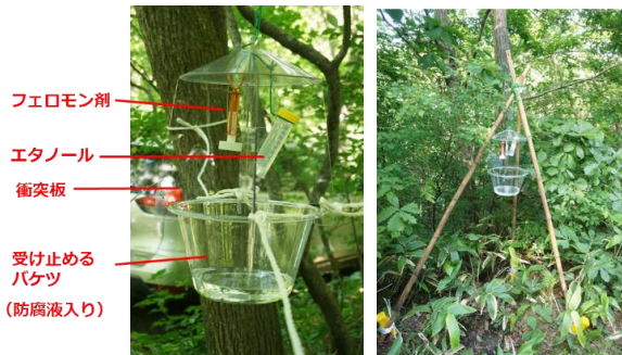
写真-2 フェロモントラップの構造と設置時の様子
