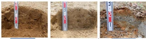
透水性 高い → 風化により粘土化が進行 → 透水性 低い
