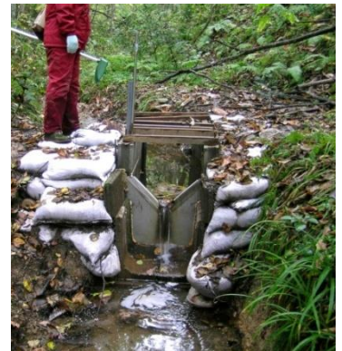
写真 観測定点に設置した流量堰(高齢級トドマツ人工林)
