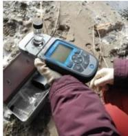
写真3 溶存鉄の現地計測
