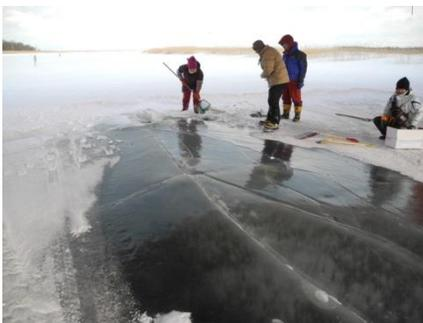
写真1 結氷下の採水作業
