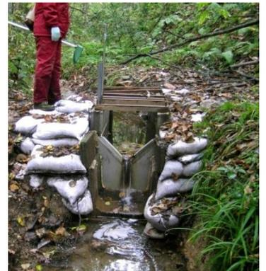
写真 観測定点に設置した流量堰(高年齢級トドマツ人工林)
