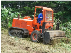
小型地形対応式育林機械 平成13年 地拵え作業 道有林岩見沢経営区 林種：未立木地 下層植生：チシマザサ
