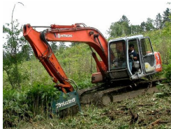
ブラッシュカッター TRH-100 平成14年度 地拵え作業 道有林上川北部管理区 林種：人工林伐採跡地 下層植生：クマイザサ
