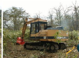
ブッシュカッターヘッド MBH1300 平成16年度 地拵え作業 道有林上川北部管理区 林種：未立木地 下層植生：チシマザサ
