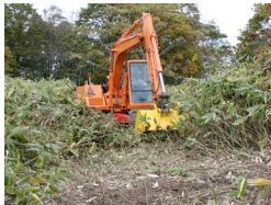
畠山式レーキ&ロータリーバケット 平成17年度 地拵え作業 滝川市市有林 林種：未立木地 下層植生：クマイザサ
