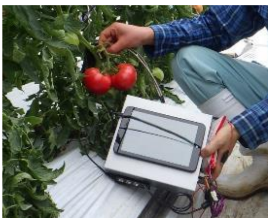
図4 可視光・近赤外光センサーによる主茎硝酸濃度の測定の様子 1) センサー部を主茎に当てて、主茎周囲を黒色ゴム製カバーで覆い太陽光の侵入を防ぐ
