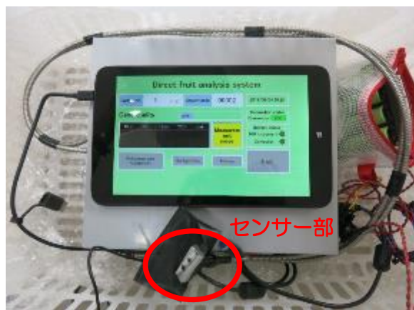
図2 可視光・近赤外光センサー装置 1) 光源：ハロゲンランプ
