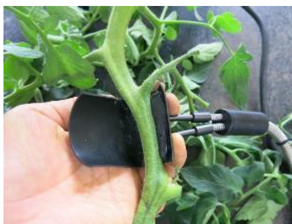
図4 可視光・近赤外光センサーによる主茎硝酸濃度の測定の様子 1) センサー部を主茎に当てて、主茎周囲を黒色ゴム製カバーで覆い太陽光の侵入を防ぐ
