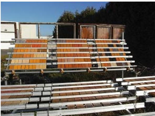
写真4 屋外暴露試験の様子
