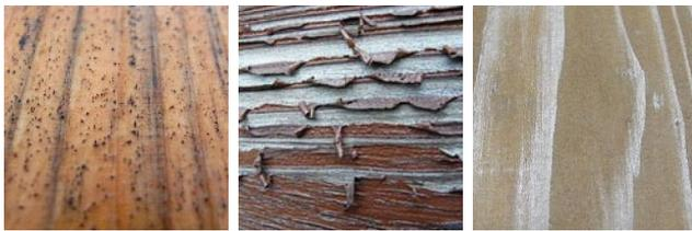
塗膜表面のカビ 厚い塗膜の劣化 薄い塗膜の劣化
