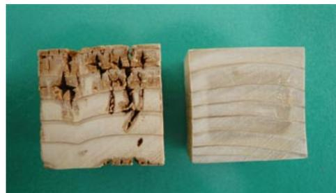
写真2 腐朽試験後の劣化状況
