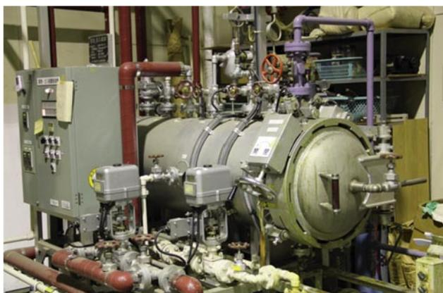
写真2 減圧加圧注入処理装置（試験用）
