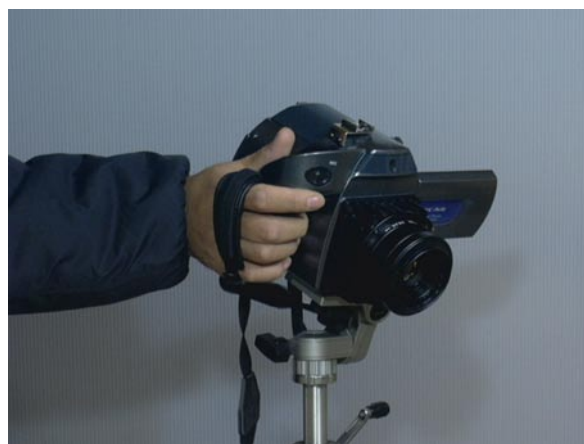
写真1 ハンディサーモグラフィー
