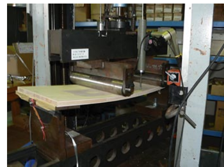
写真 3 合板の曲げ試験
