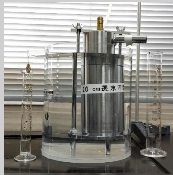
室内透水試験
