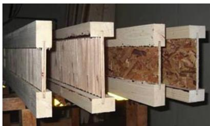
写真5 I形梁の断面種類
