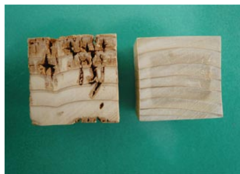
写真2 腐朽試験後の劣化状況 (左: 無処理材, 右: アセチル化材, 樹種: トドマツ, 試験期間: 4か月, 木口断面にて観察)
