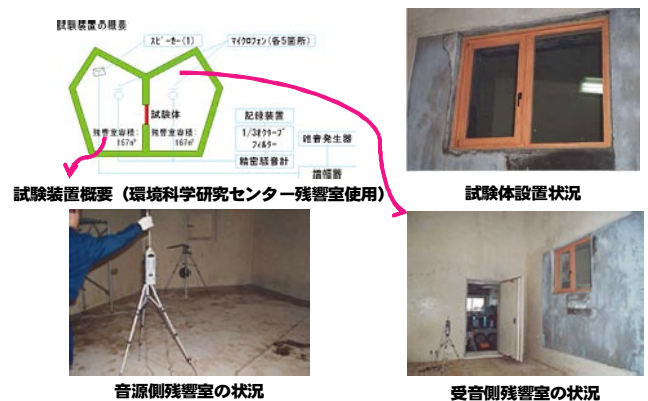
図2 残響室法による測定
