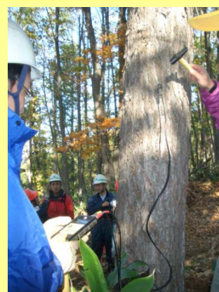
写真3 応力波伝播速度の測定
