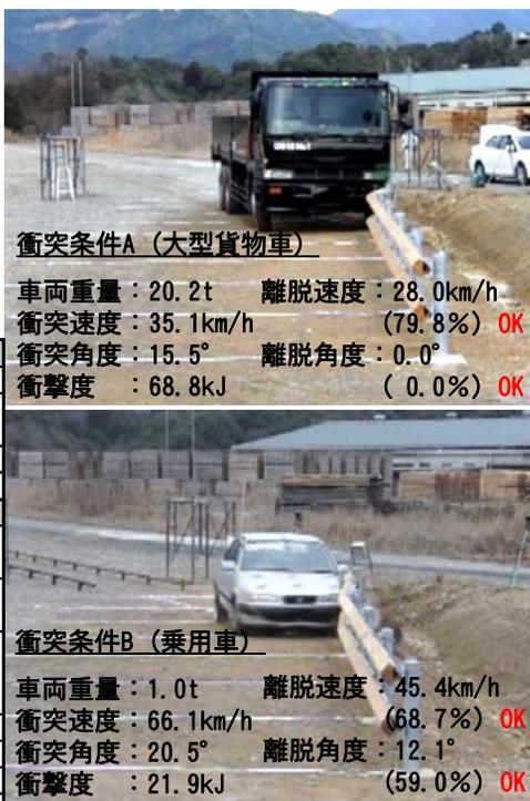
写真1 実車衝突試験の様子および結果
