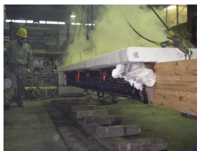
写真 準耐火性能試験の様子
