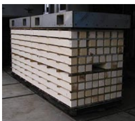
写真1 栈積みの状況
