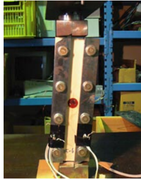
写真2 面内せん断試験
