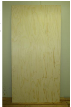
写真4 試作した内装用合板
