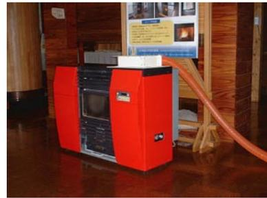
写真5 レシーバ (北海道型ペレットストーブに仮設)
