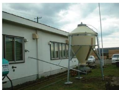
写真1 バネコンの使用例（搬送距離は2～3m）
