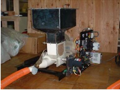
写真2 試験機 (ペレット供給・送風側)
