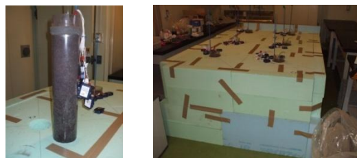
写真－1 土壌凍結観測装置。 a) 土壌サンプル， b) 装置の全景。
