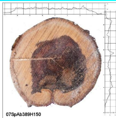
図-2 ナナカマド正常部と腐朽部の貫入抵抗値
