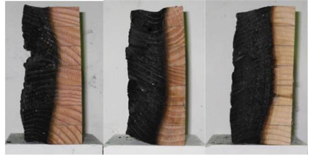
写真2 加熱終了後の試験体の断面
