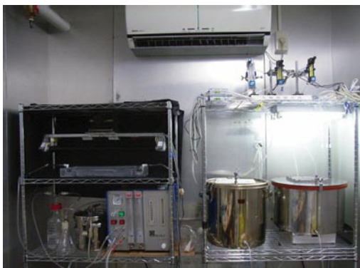
光触媒材料の性能試験
