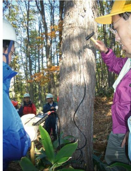
伐採前に木材の強度性能を推定する試み
