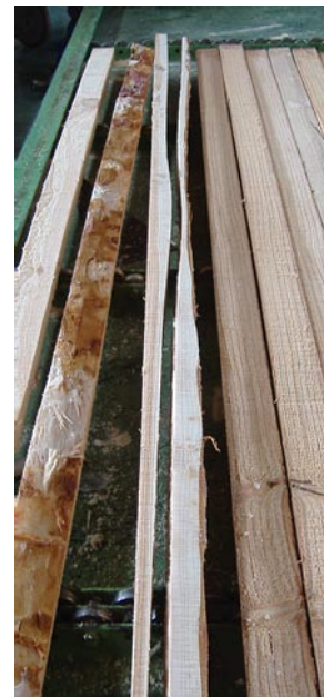
写真1 (上) のこ屑の固着 写真2 (右) 挽き曲がり
