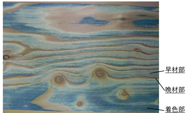
写真 カラマツを用いて製造された色彩浮造り合板
