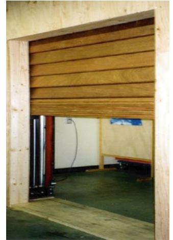
写真4 木製シャッター
