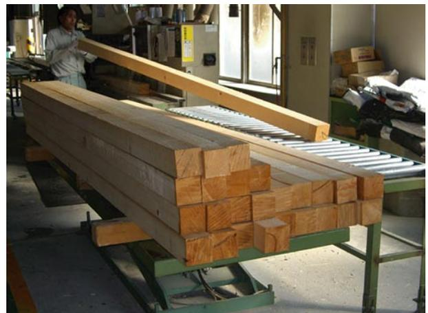
写真 材面を見ながらの荒削り作業
