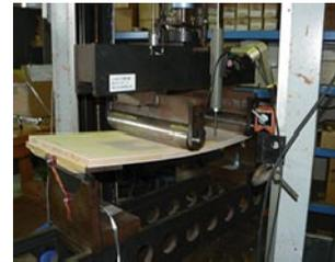
写真4 依頼試験による合板の曲げ試験
