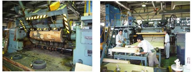
写真3 ローターレースによる単板切削
