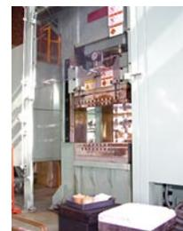
蒸気噴射型ホットプレス
