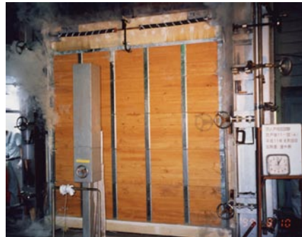
写真13 防火試験の様子
