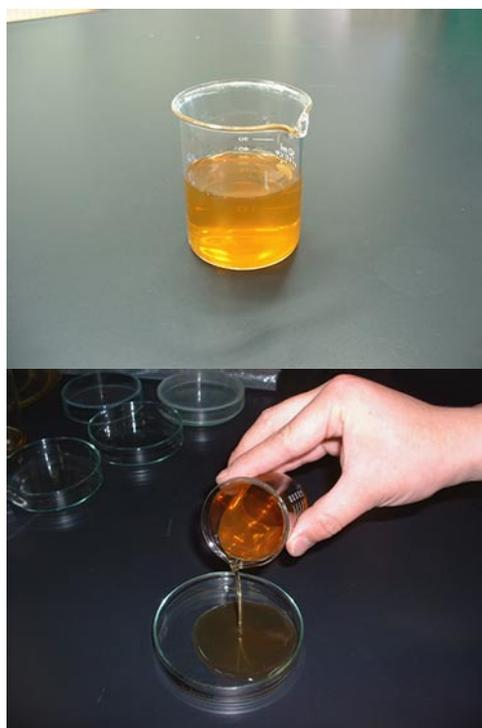
写真2 カニ殻より製造したキトサン溶液
