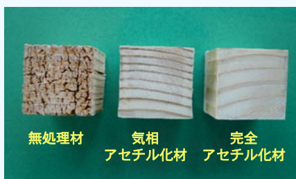
図3 木材腐朽菌に対する耐朽試験結果 （材：トドマツ心材，腐朽菌：オオウスラタケ）
