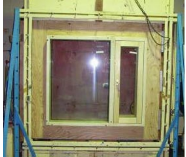
図 3 開口部の気密・水密性試験
