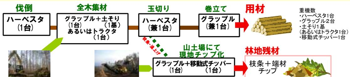
図－1 枝条・端材集荷システムの例
