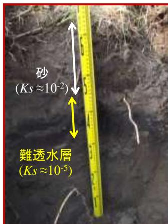
写真-1 激害区内での埋没火山灰層(難透水層)の様子。
