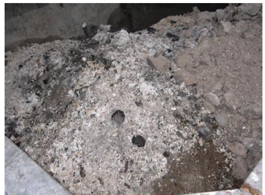
写真3 木屑だきボイラーの燃焼灰
